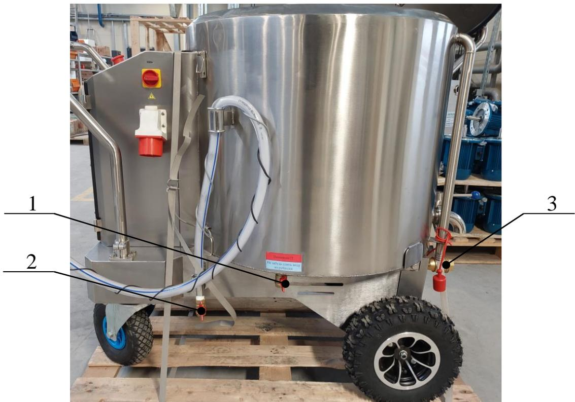
1 – кран слива воды с водяной рубашки; 2 – кран слива воды со шланга; 3 – быстроразъёмное соединение
