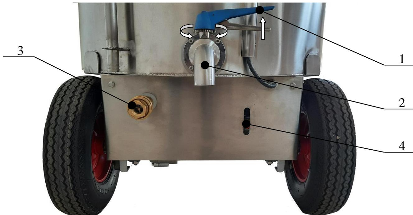
1- Затвор дисковый DN40 S-S; 2-отвод 40x1,5 DN 40 S-S; 3 – быстросъемное соединение из латуни; 4 – рукоятка тормоза
