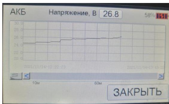
Рисунок 6.7 – График зависимости напряжения аккумулятора от времени
