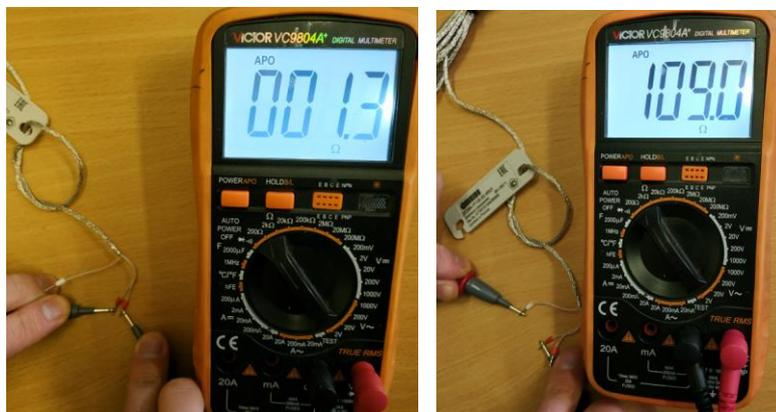
Рисунок 8.11 – Сопротивление между проводами датчика температуры Pt100
