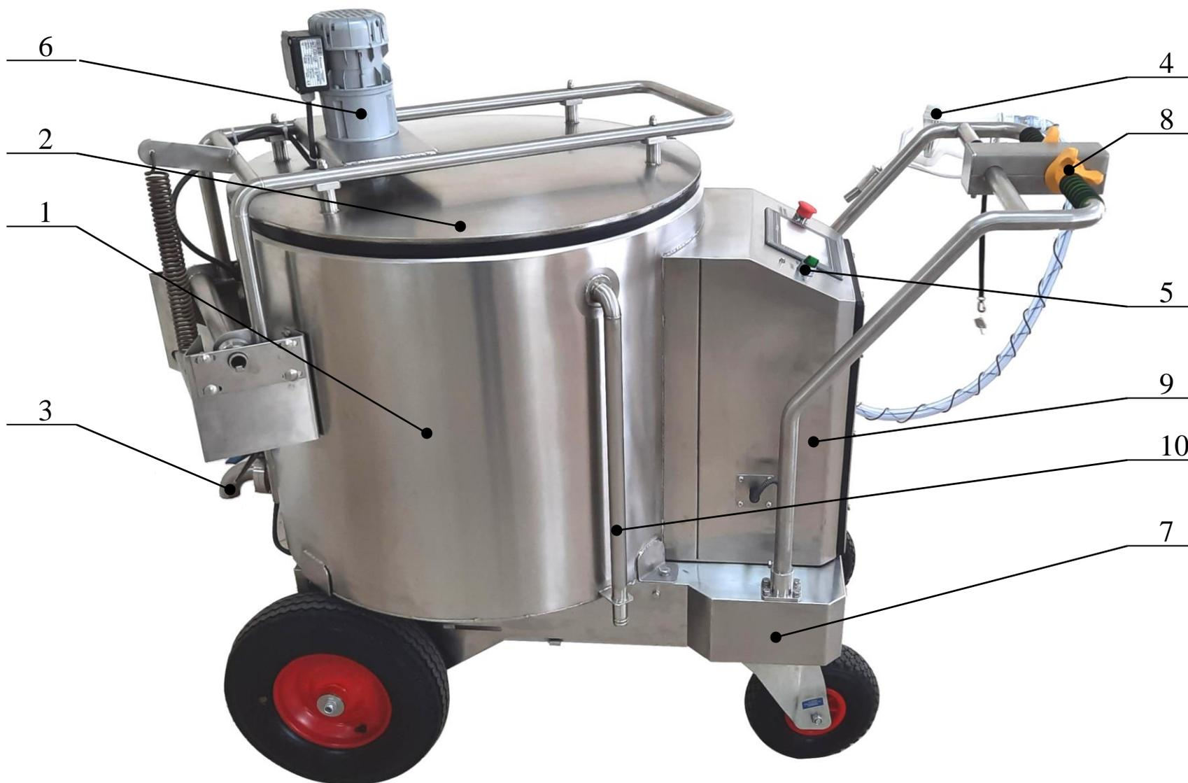
1 – теплоизолированный резервуар; 2- откидная крышка; 3 – сливной кран; 4 – пистолет-дозатор; 5 – переключатель пистолета-дозатора; 6 – электродвигатель мотор-мешалки; 7 – шасси; 8 – лепестки управления; 9 – электрический шкаф; 10- труба слива
