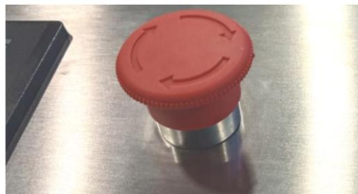
Рисунок 5.3 – Фото кнопки «Аварийная остановка» в положении «Выкл»
