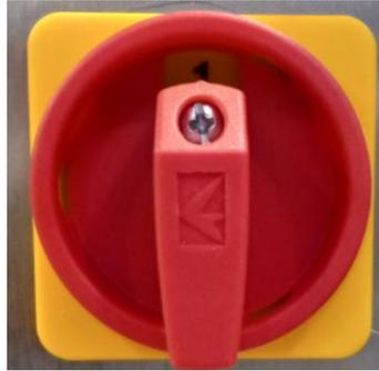
Рисунок 5.1 – Положения переключателя «ВКЛ» на боковой стенке пастеризатора
